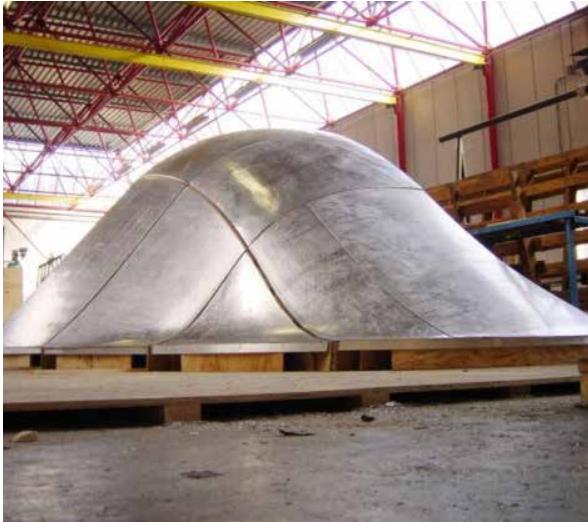
FIG. 7.8 Productie en montage van 3D vervormde aluminium panelen op holle mal explosief geperst Hoofddorp, zie 7.1.
