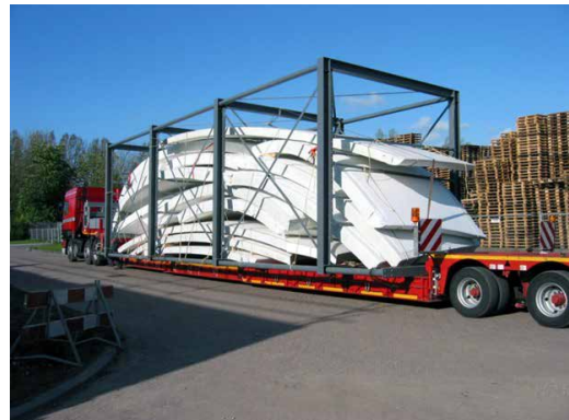
FIG. 7.13 Productieopname van de polyester schaal van een segment en de stapeling van transportabele segmenten in een transportcontainer voor het Rabin Center
