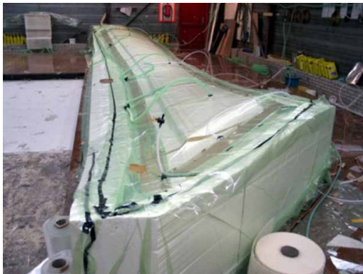
FIG. 7.13 Productieopname van de polyester schaal van een segment en de stapeling van transportabele segmenten in een transportcontainer voor het Rabin Center
